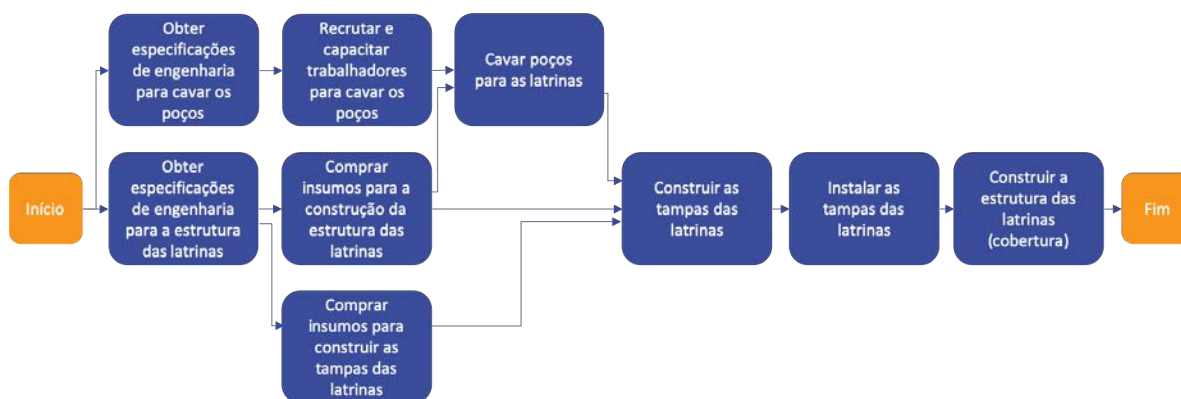
Figura 34: Usando o Diagrama de Rede para sequenciar as atividades de construção de latrinas
